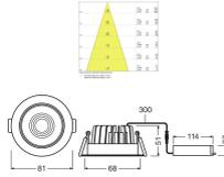
Technische Daten Ledvance LED Deckenstrahler Einbau Silber 8W 670lm 36D - 840 | Ausschnitt 68mm - Dimmbar
