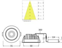
Technische Daten Ledvance LED SPOT feuerfest Silber 8W 620lm 36D - 830 | 81mm - IP65 - Dimmbar
