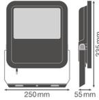
**Technische Daten Ledvance LED-Scheinwerfer GEN 3 Schwarz 80W 10000lm 100D - 865 | IP65 - Symmetrisch - Ersatz für 250W**
