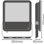
**Technische Daten Ledvance LED-Scheinwerfer Photocell GEN 3 Schwarz 200W 25000lm 100D - 840 | IP65 - Lichtsensor - Symmetrisch**
