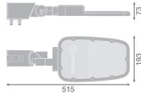
Technische Daten Ledvance LED-Scheinwerfer Area mittel Grau 65W 8450lm 160x58D - 730 | IP66 - Symmetrisch
