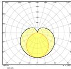
Technische Daten Ledvance LED Röhre T8 Performance (UN) Ultra Output 23W 3700lm - 865 | 150cm - Ersatz für 58W
