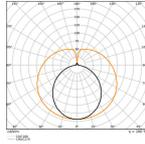
Technische Daten Ledvance LED Röhre T8 EM Superior Conventional (EM), Mains (AC) Standard Output 5.1W 900lm - 840 Kaltweiß | 44cm - Ersatz Für 15W
