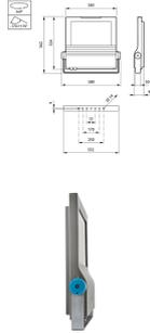
Technische Daten Philips Led-Scheinwerfer ClearFlood BVP650 Aluminium 178W 26100lm 88x187D - 740 | IP66 - Symmetrisch
