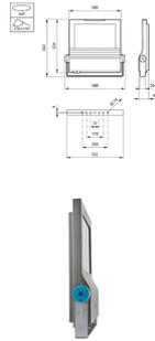
Technische Daten Philips Led-Scheinwerfer ClearFlood BVP650 Aluminium 220W 30960lm 83x130D - 740 | IP66 - Symmetrisch
