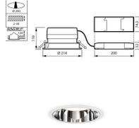
Technische Daten Philips LED Downlight LuxSpace Kompakt tief DN571B 19.8W 2200lm 75D - 830 | 214mm - Aluminium Reflektor - 3 Stunden Notbeleuchtung
