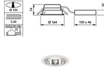
Technische Daten Philips LED Downlight LuxSpace Mini DN560B 9W 1350lm
