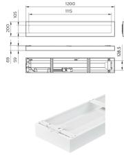
Technische Daten Philips LED Panel CoreLine SM136V 22/31W 2800-4000lm - 830 | 120x20cm - UGR <19 - Dali Dimmbar - Wählbare Wattzahl - W5
