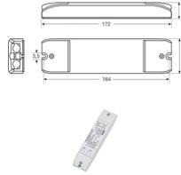
Caractéristiques Osram LED driver Optotronica CV 1-10V | Dimmable
