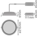
**Caractéristiques Ledvance Spot encastrable LED DN200 Blanc 35W 3150lm - 865 | 215mm - Diamètre 200mm - IP44**
