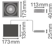
**Caractéristiques Ledvance Spot LED Carré inclinable Noir-Blanc 30W 2700lm 36D - 830 Blanc Chaud | Diamètre 164mm**
