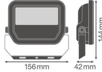
Caractéristiques Ledvance Projecteur LED GEN 3 Noir 20W 2400lm 100D - 865 | IP65 - Symétrique - Remplacement 50W
