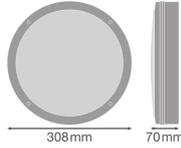
Caractéristiques Ledvance Surface Bulkhead 300 15W 840 1400lm Blanc IP65 | Éclairage de secours 3H
