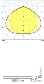
**Caractéristiques Ledvance LED Rail de fixation suspendu Trusys Flex Claire 70W 12100lm 120D - 840 Blanc Froid | Dali Dimmable**
