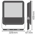
**Caractéristiques Ledvance Projecteur LED 250 Aluminium Blanc 167W 25000lm 100D - 865 | IP66 - Symétrique**
