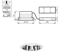
Caractéristiques Philips Spot encastrable LED LuxSpace Compact profond DN571B VLC-E 10.3W 1300lm 75D - 830 | 214mm - Aluminium Réflecteur - Dali Dimmable
