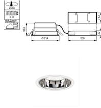
Caractéristiques Philips Spot encastrable LED LuxSpace Compact bas DN570B 19.8W 2200lm 80D - 840 | 214mm - Aluminium Réflecteur - Éclairage de secours 3 heures
