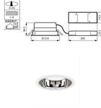
Caractéristiques Philips Spot encastrable LED LuxSpace Compact bas DN570B VLC-E 20.9W 2600lm 80D - 830 | 214mm - Aluminium Réflecteur - Dali Dimmable
