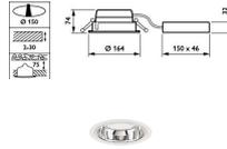
Caractéristiques Philips Spot encastrable LED LuxSpace Mini DN560B 9W
