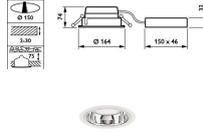
Caractéristiques Philips Spot encastrable LED LuxSpace Mini DN560B 9W
